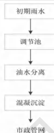
图 4-2 “隔油+混凝沉淀”处理工艺流程图
